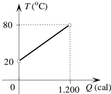
Aquecendo-se esta amostra até 100°C e, em seguida, mergulhando-a em 500 g de água (calor específico igual a 1 cal/g°C) a 40°C, podemos afirmar que a temperatura final de equilíbrio do sistema vale, aproximadamente:
